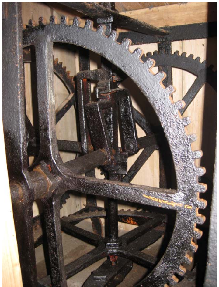
Afbeelding 27: verdeelinrichting naar de 3 wijzers.
