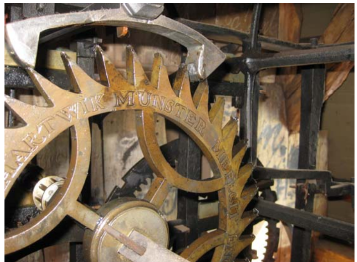
Afbeelding 25: bronzen ankerrad met naam van Hartwig Münster 1754.
