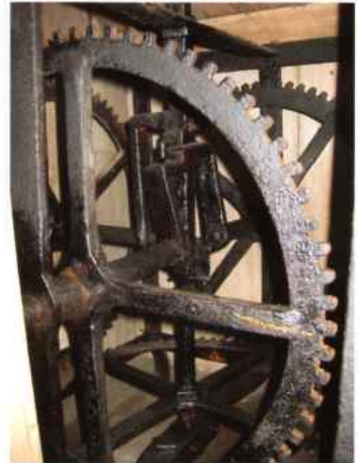
Afbeelding 3: Ingenieuze verdeelinrichting (1609) naar drie wijzerplaten aan de toren.
